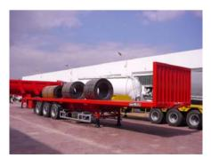
Une construction de châssis spécifique utilisant des aciers très résistant pour obtenir une charge utile exceptionnelle
