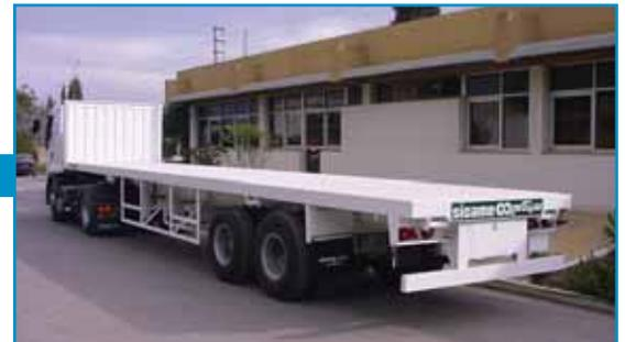
Châssis mécano-soudé en acier spécial de forme arrière dégressive, assurant une grande souplesse et une robustesse à toute épreuve
