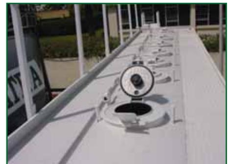
Chaque compartiment est équipé d'un clapet de sécurité et d'un trou d'homme avec soupape de sécurité.
