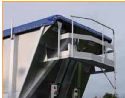
Bâchage latéral avec passerelle. Débâchage latéral complet. Bâche à sangles.
