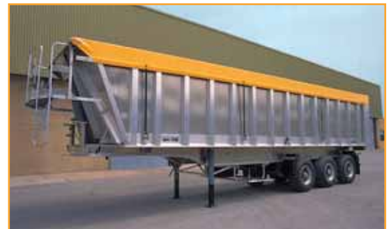
Bennage frontal. Caisse en aluminum naturel. Châssis en acier. Porte roue simple.
