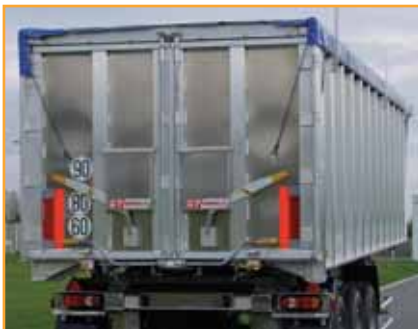
Porte arrière universelle avec traverse supérieure. Ouverture en hayon à 2 vantaux avec fermeture double et 2 potillons céréaliers.
