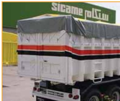
Porte arrière universelle offrant les fonctions d'ouverture en hayon, à 2 vantaux avec fermeture double et portillons céréalières.
