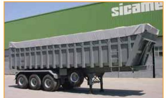
Dotée d'un bâchage dont la tension est assurée par sandows, protégeant ainsi la cargaison. Accès assuré par 2 échelons latéraux.
