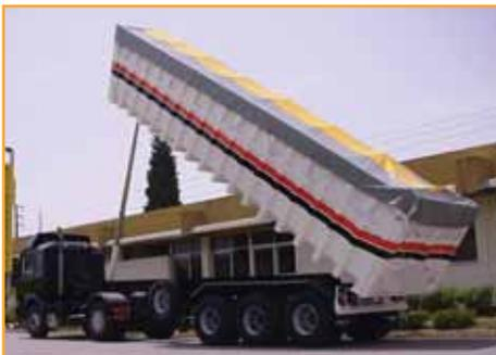
Bennage assuré par un vérin frontal. Dispositif de blocage de la caisse sur châssis par verrou HYFIX, garantissant une sécurité maximale lors du parcours.
